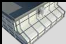
Sitzbank mit Mulde für ausrollbare Abdeckung
